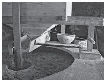
Fig.103 – 2005 Set. Moenda ainda em funcionamento para moagem de milho para animais.
