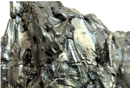
SÃO MIGUEL - ESCÓRIAS COM PELÍCULA DE VIDRO VULCÂNICO BASÁLTICO (SIDEROMELANA)
